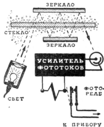
Схема процесса измерения влажности в помещении, где производится сушка готовой продукции.
